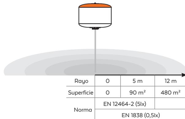
entender el esquema : en un rayo de acción de 12 metros, una superficie de 480m<sup>2</sup>, se garantiza una eficiencia conforme a la norma EN1838
